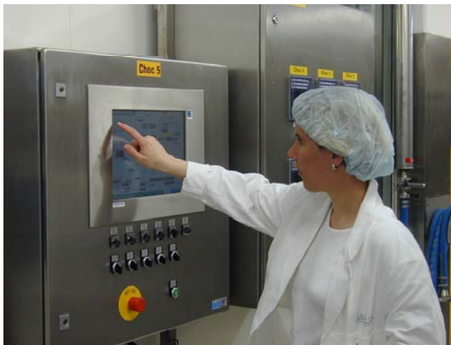
Abbildung 6: Industrie-PC als Touchpanel für einfachste Bedienung
