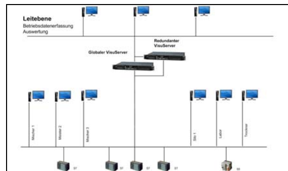
Redundantes-Client-Serversystem mit Kopplung zur Leitebene
