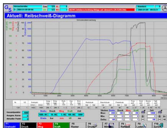
Reibschweißmaschine mit Kurvendarstellung von Prozesswerten Druck, Drehzahl und Kraft und Protokollen für jedes hergestellte Produkt
